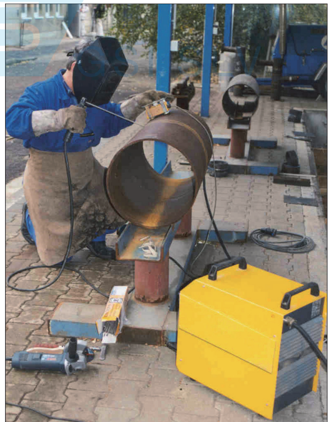
Abbildung 40: Fallnahtschweißen mit zelluloseumhüllten Stabelektroden
