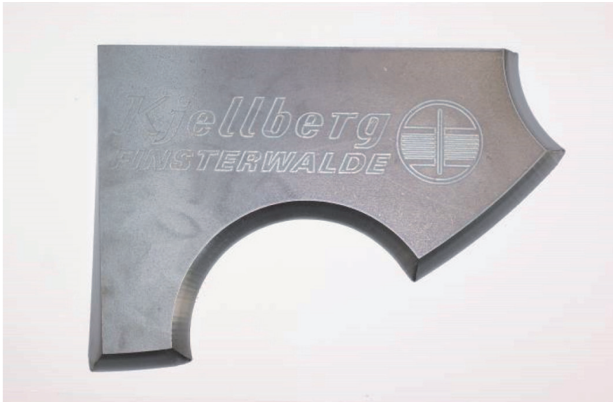
Abbildung 39: Schnittmuster mit variierender Fase und oberflächlicher Markierung
