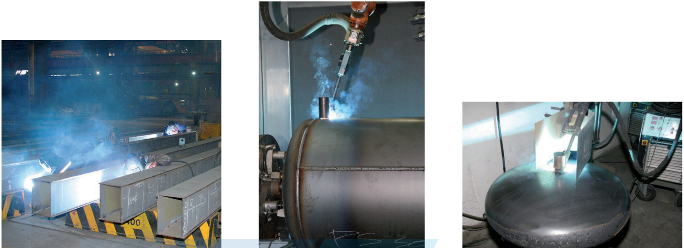
Abbildung 1: Anwendungsbeispiele des MSG-Schweißen im Stahl- und Behälterbau (Quelle Abicor Binzel)
