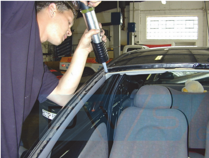
Abbildung 20: Strukturelevante Klebung einer Pkw-Windschutzscheibe
