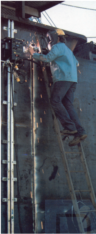
Abbildung 16: Mechanisiertes MAG-Fülldrahtschweißen der Sektionsstöße im Schiffbau (Quelle: Aker Werft, Warnemünde)
