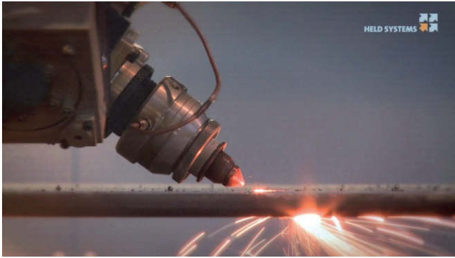
Abbildung 58: Prozessansicht auf das Laserstrahlbrennschneiden unter 45°
