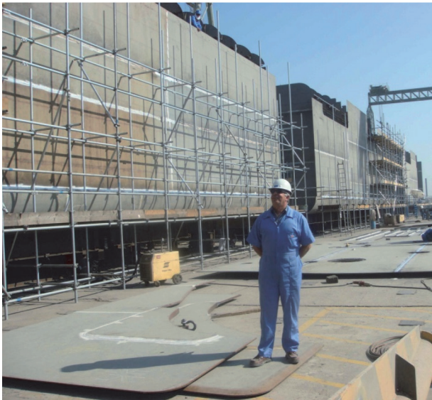
Abbildung 18: Vorfertigung der Pontons einer Bohrinself (Quelle: Nöll-IMAC/MCC, Abu Dhabi)
