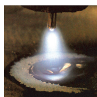
MIG-Auftragschweißung auf Stahl mit vorausgehendem Reinigungshof (Impulslichtbogen, Pluspolung)
