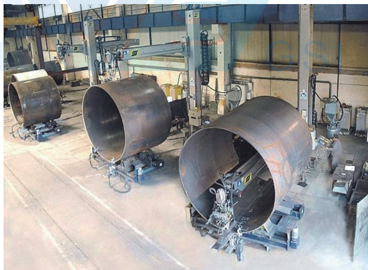
Abbildung 35: Längsnahtschweißen von Rohrschüssen (ESAB)
