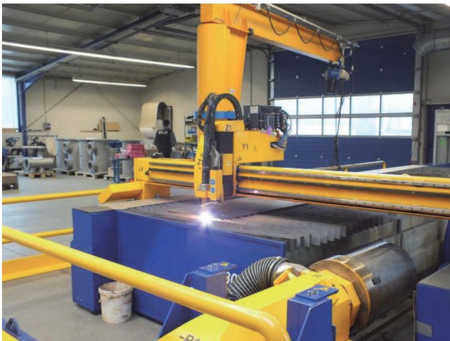
Abbildung 43: Kombination aus Flachbett-Führungsmaschine und Rohrschneidanlage
