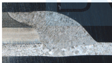
Abbildung 58: Kehlnaht am Überlappstoß mit Impulslichtbogen geschweißt
