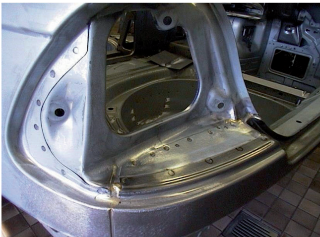
Abbildung 4: Anwendungsbeispiel MSG-Lötverbindungen im PKW-Karosseriebau (Quelle EWM)
