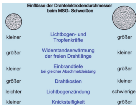
Abbildung 46: Einflüsse der Drahtelektrodenndurchmesser beim MSG-Schweißen
