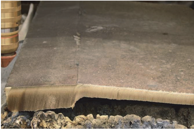
Abbildung 30: Probeschnitt an einer Schiffsschraube (Alu-Bronze-Guss, Materialdicke 24 bis 48 mm)
