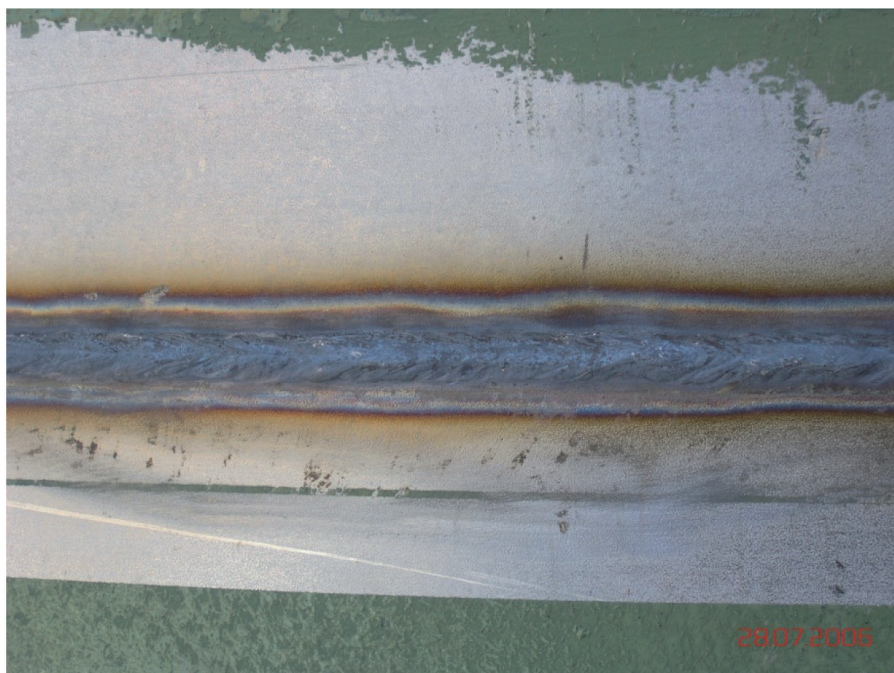
Abbildung 15: „Verbrannte“ Schweißnahtwurzel durch absolut ungenügenden Gasschutz
