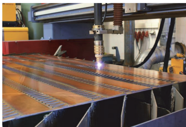
Abbildung 29: Schneiden von Kupferstegen für Schneidisch
