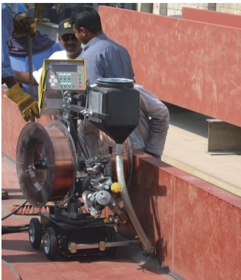
Abbildung 18: UP-Kehlnahtschweißen mit dem Tandemverfahren und eine Tandemschweißnaht (Werkbilder: ESAB)
