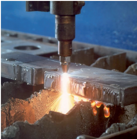
Abbildung 2: Schneidbrenner im Einsatz
