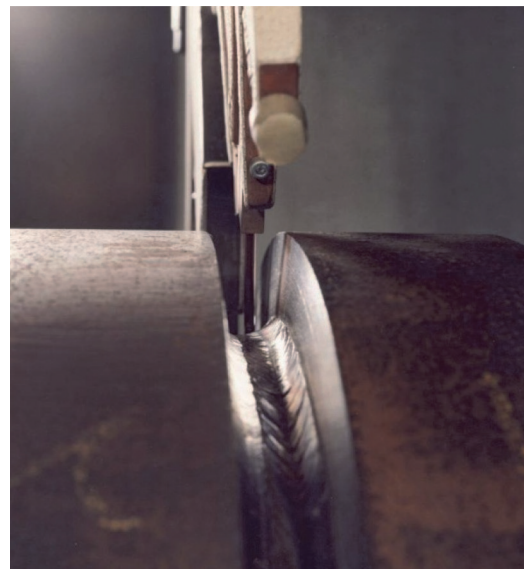
Abbildung 18: UP-Kehlnahtschweißen mit dem Tandemverfahren und eine Tandemschweißnaht (Werkbilder: ESAB)
