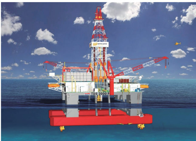
Abbildung 17: Halbtaucher-Bohrinsel (Drilling Rig TDS 2000 P) (Quelle: GPS/MCC, Abu Dhabi)
